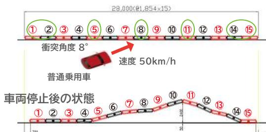
「ワイヤーロープ+強固な連結」がなければ車両が突き抜けてしまうところ、すべてのウォーター・ケーブル・バリアーを満水にしなくとも、車両を停止させることができました。
