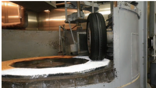
ラベリング試験実施状況
