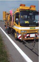
水性路面標示材速乾工法
